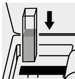
Colocar la cubeta en el compartimiento para cubetas. La medición es efectuada automáticamente.
