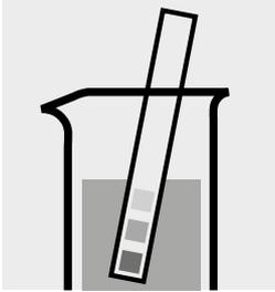
Comprobar el valor del pH de la muestra, intervalo necesario: pH 4–9. En caso necesario, corregir el valor del pH añadiendo gota a gota solución diluida de hidróxido sódico o de ácido sulfúrico.
