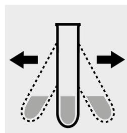
Agitar intensamente el tubo para disolver la sustancia sólida.
