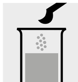
Añadir 1 microcuchara azul rasa de **AI-1** al tubo de ensayo y disolver la sustancia sólida.
