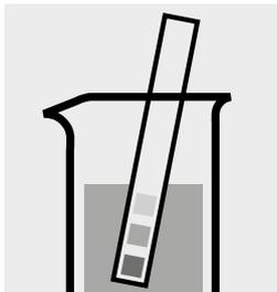
Comprobar el valor del pH de la muestra, intervalo necesario: pH 6–8. En caso necesario, corregir el valor del pH añadiendo gota a gota solución diluida de hidróxido sódico o de ácido sulfúrico.
