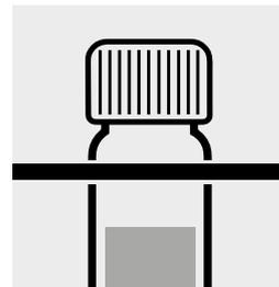
Sacar ambas cubetas del termorreactor, dejarlas enfriar en un soporte para tubos de ensayo.
