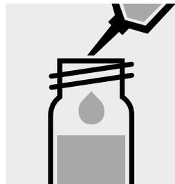
Pipetear 1,0 ml de la **muestra preparada** en una cubeta de reacción, **no mezclar**.
