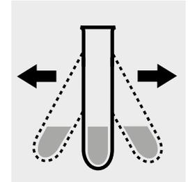
Agitar intensamente el tubo para disolver la sustancia sólida.
