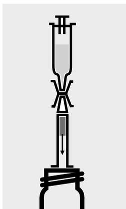
Colocar la pieza de conexión en el extremo inferior de la columna. Transferir a una cubeta vacía el carbón de la columna con 10 ml de **AOX-5** mediante una jeringa de plástico.
