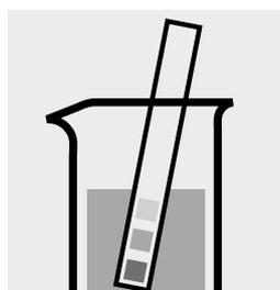
Comprobar el valor del pH de la muestra, intervalo necesario: pH 1–7. En caso necesario, corregir el valor del pH añadiendo gota a gota solución diluida de hidróxido sódico o de ácido sulfúrico.
