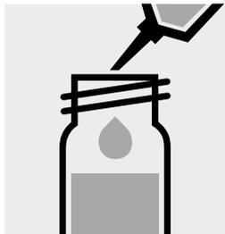
Añadir 3,0 ml de la **muestra desenriquecida** con la pipeta **cuidadosamente** en una cubeta de reacción, cerrar firmemente con tapa roscada y mezclar intensamente. **¡Atención, la cubeta se calienta!**
