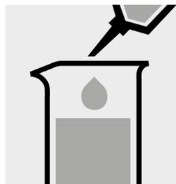
Añadir 1 ml de **ácido clorhídrico 1 mol/l Titripur®** (art. 1.09057) con la pipeta y mezclar.
