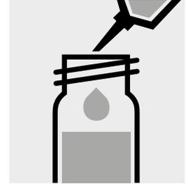
Añadir 7,0 ml de la muestra con la pipeta en una cubeta, cerrar con la tapa roscada y mezclar.
