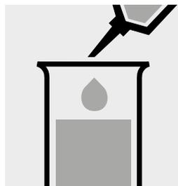
Pipetear 0,50 ml de H<sub>2</sub>O<sub>2</sub>-1 en un tubo de ensayo.
