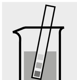
Comprobar el valor del pH de la muestra, intervalo necesario: pH 2–11. En caso necesario, corregir el valor del pH añadiendo gota a gota solución diluida de hidróxido sódico o de ácido sulfúrico.
