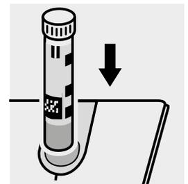
Colocar la cubeta en el compartimento para cubetas. Hacer coincidir la raya de marcado de la cubeta con la marca de fotómetro.
