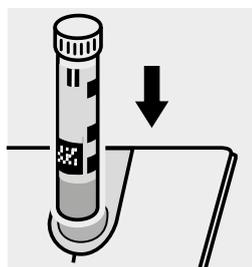
Colocar la **cubeta PO<sub>4</sub>-P** en el compartimiento para cubetas. Hacer coincidir la raya de marcado de la cubeta con la marca de fotómetro. La medición es efectuada automáticamente.
