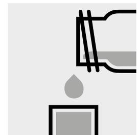
Introducir la muestra de medición en la cubeta y medir **inmediatamente**.
