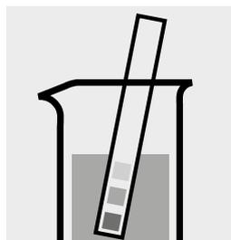
Comprobar el valor del pH de la muestra, intervalo necesario: pH 2–12.
