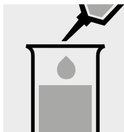
Pipetear 0,50 ml de  $\text{SO}_4$ -1 en un tubo de ensayo.
