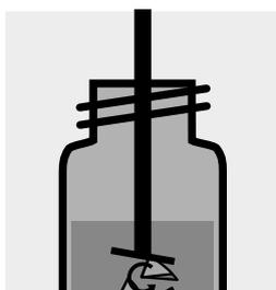
Desmenuzar el filtro con un homogeneizador. Enjuagar y juntar con algo de etanol.
