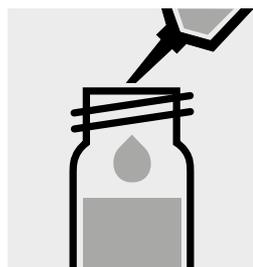
Añadir 5,0 ml de **isobu-tilmetilcetona p. a.** (art. 1.06146) con la pipeta, cerrar con la tapa rosca-da.
