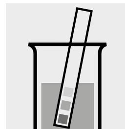
Comprobar el valor del pH de la muestra, intervalo necesario: pH 2,0–2,5. En caso necesario, corregir el valor del pH añadiendo gota a gota solución diluida de hidróxido sódico o resp. de ácido sulfúrico.
