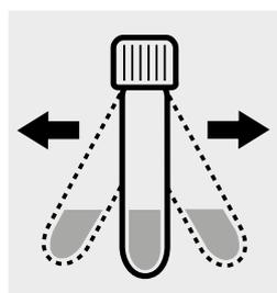
Agitar intensamente **durante 5 segundos** para disolver la sustancia sólida.
