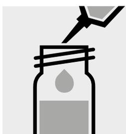
Pipetear 0,20 ml de **AOX-1K** en una cubeta de reacción y mezclar.
