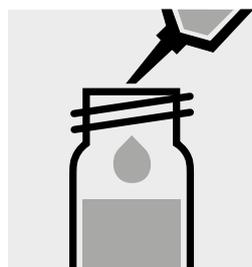
Añadir 1,0 ml de **ácido fosfórico 85 % p. a.** (art. 1.00573) con la pipeta. Cerrar con la tapa roscada y mezclar.
