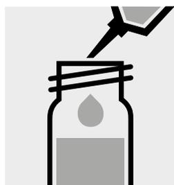
Añadir 0,50 ml de la muestra con la pipeta en una cubeta de reacción, **no mezclar**.
