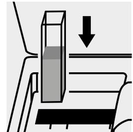
Introducir la cubeta en el compartimiento para cubetas. La medición es efectuada automáticamente.
