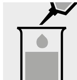
Añadir 10 ml de la muestra con la pipeta y mezclar.
